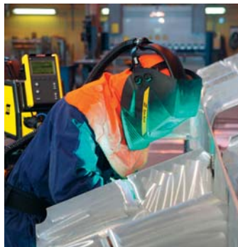
Hliník se stále více používá při stavbě lodí. Fotografie ukazuje svařování hliníku metodou MIG materiály OK Autrod 5183 a svařovacím zdrojem Aristo®Mig s řídicí jednotkou U8.
