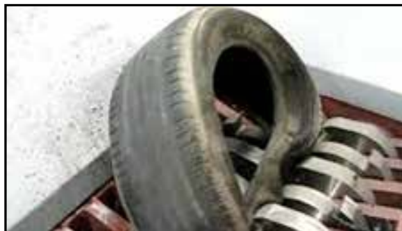
Materiál elektrody Stoody M7-G nanesený na nože drtiče pro recyklaci kovového šrotu
