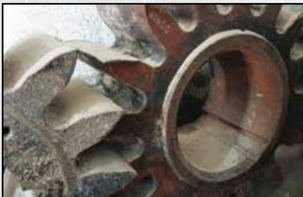
Materiál elektrody OK Tooltrode 50 nanesený na ozubená kola
