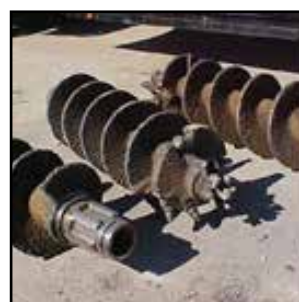
Oprava dopravníkového šneku pomocí elektrod Stoody 160 FC
