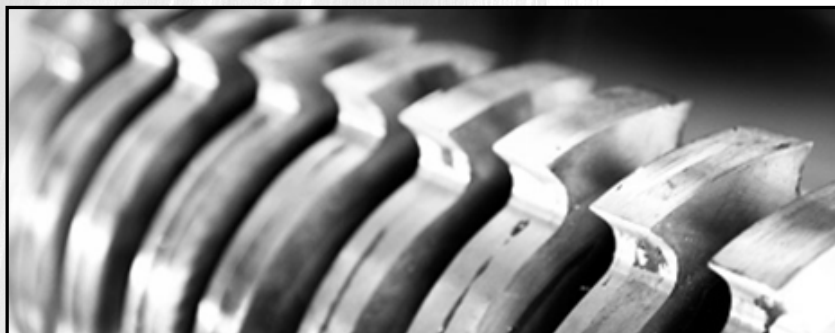
Materiál elektrody Stoody M7-G nanesený na nože drtiče pro recyklaci kovového šrotu
