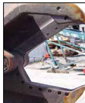
Navarování tvrdých vrstev na demoliční nůžky LaBounty pomocí elektrod Stoody 964 APG.
