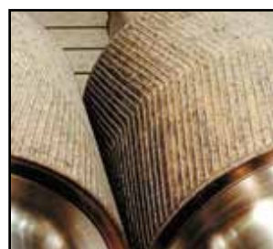
Materiál elektrody Stoody 600 nanesený na drtiči rudy.
