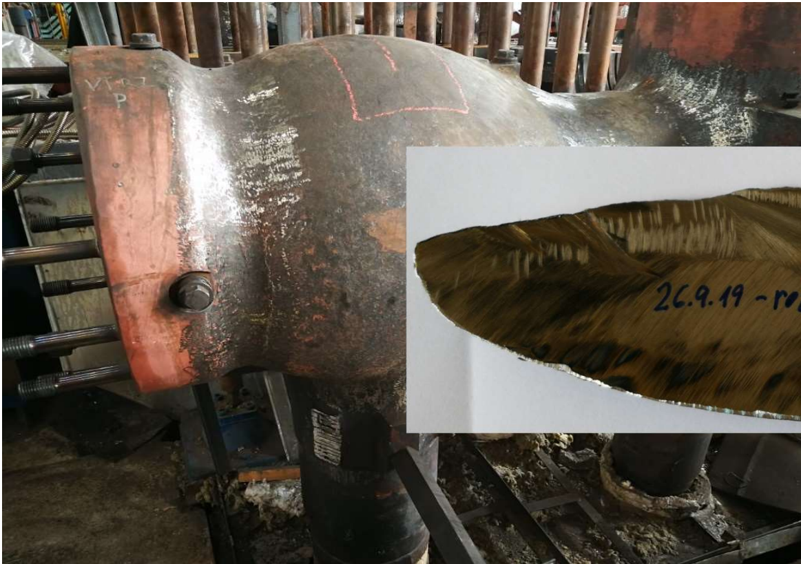
Dodaný vzorek z odběru poškozeného ventilu LEDVICE 2019
