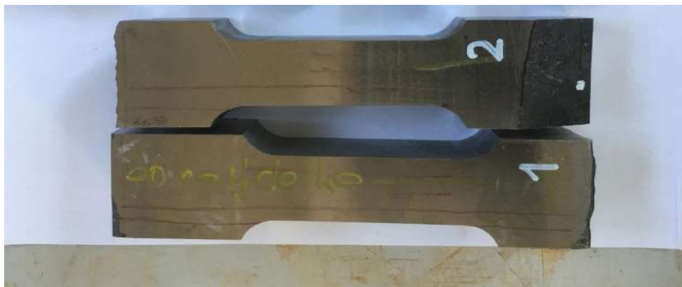
Vzorky pro zkoušku tahem svarové výplně (polotovary)
