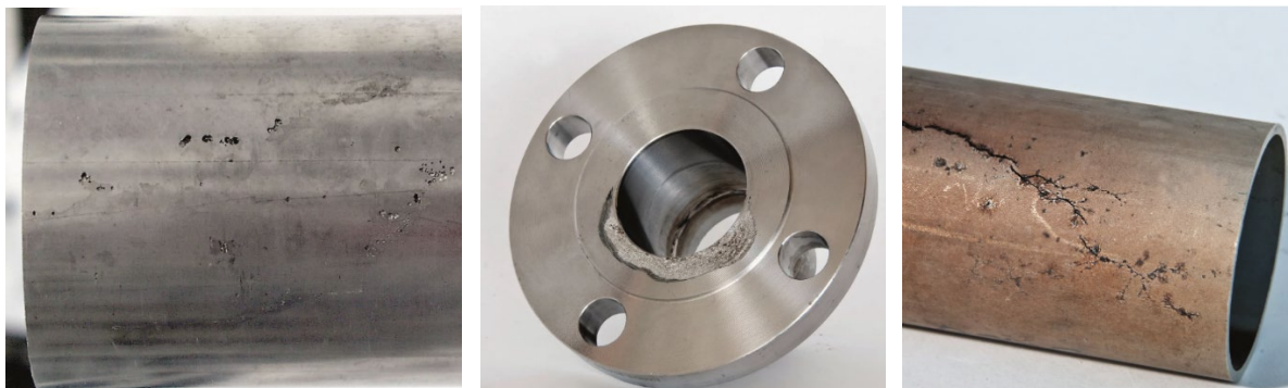
Obrázek 4: Příklady a mechanismus lokálních forem koroze
